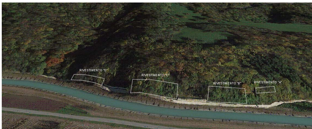
Figura 9: Sintesi degli interventi: N. 4 fasce soggette a rivestimento/rafforzamento corticale, previo esbosco, disgaggio, pulizia; sistemazione del tratto di strada con messa in opera di nuovo strato di stabilizzato; pulizia e ripristino alveo ruscello; sistemazione della recinzione in rete metallica lungo la difesa spondale.
